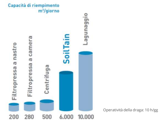
Disidratazione fanghi mediante geotessili tubolari
