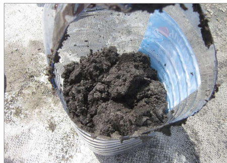
Risultato del processo di dewatering (~ 45 % DS)
