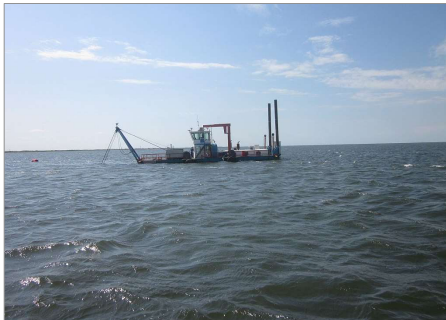
4 draghe (2 da 1.800 m 3 /h e 2 da 1.200 m 3 /h)
